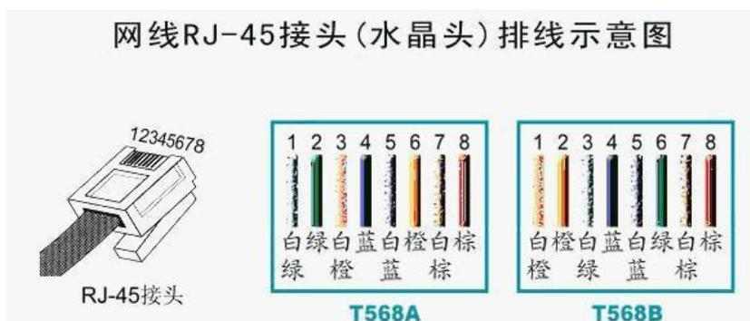
网线有两种线序排列方式，为 T568A 类和 T568B 类，如果用于终端机与 HUB 相连，网线两端的线序必须相同，A 类线序或 B 类线序。如果用于终端机与电脑直接相连（不经过 HUB）则两端的线序不同，采用
